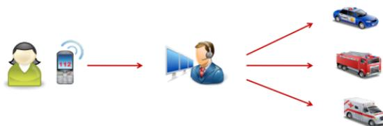
*Modello PSAP Interconnessi (variante).* Tutti i PSAP usano la stessa tecnologia e sono interconnessi alla stessa rete. Le chiamate possono essere indirizzate a qualunque operatore. È il più efficiente: tutti i PSAP utilizzano la stessa tecnologia. Esempi: Bulgaria, Repubblica Ceca, Svezia.
